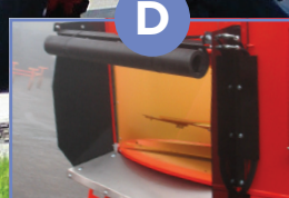
D Opcje drzwi Boczne, przednie i tylne opcje wyładunku paszy.
