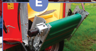
E Przenośniki wyładowcze W modelach wozów z pionowymi ślimakami wyposażonych w drzwi boczne dostępna jest opcja zamontowania hydraulicznych przenośników wyładowczych umożliwiających podawanie do karmideł.
