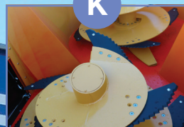
K Noże Ząbkowane noże (na każdym ślimaku) zapewniające szybkie i kompleksowe mieszanie wszystkich składników.
