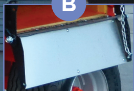
B Podajniki na zawiasach Możliwość zrzucania materiału bezpośrednio na podłogę lub na różne wysokości.
